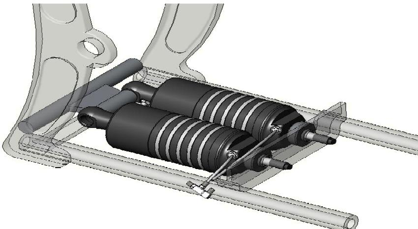
3. **Fixer l'arrière de l'amortisseur (graisser la partie lisse des boulons ainsi que les filetages) :**
