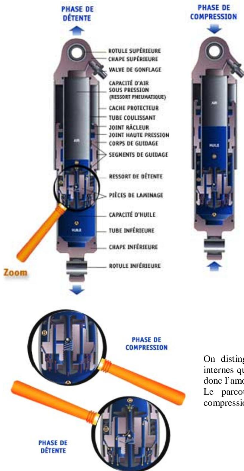
C'est le passage de l'huile à travers des petits orifices pratiqués dans la pièce de laminage, qui amorti les mouvements du combiné.
